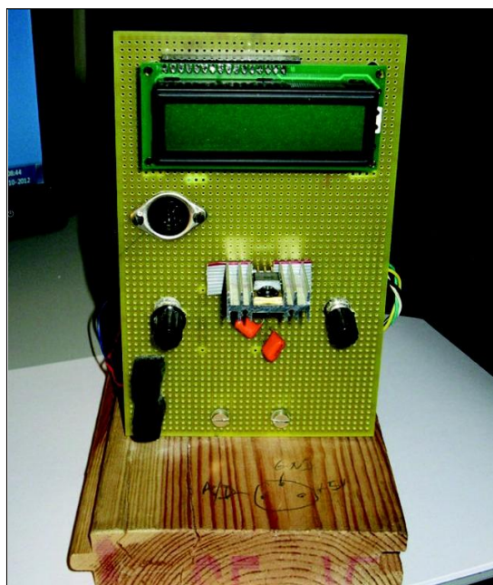
Foto 1. Gulvbrædt er min Arduino Uno R3 til programudvikling. Den er derfor forsynet med adskillige tilføjelser:
